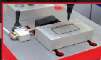
Blocca targhette pneumatico, su misura Vacuum-pneumatic nameplates
